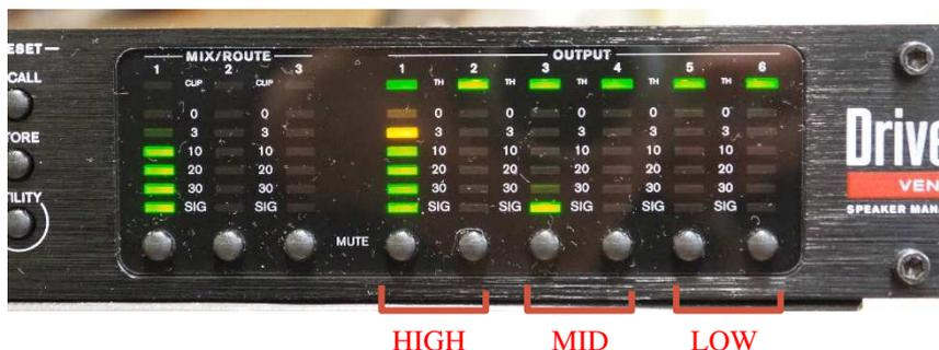
もし誤って LOW と HIGH を入れ替えてケーブルを接続してしまうと、音を出した途端にツイーターを吹っ飛ばす可能性があります。間違えないように、黄色のテープに LOW、MID、HIGH と印刷し、ケースの上面の背面に近いところに貼りました。この位置に貼れば、ケーブル接続時だけでなく、Output Mute Button を操作するときにも間違わずに済みます。
